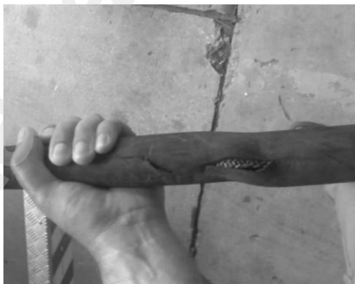
Figura 3 – Desgaste por revestimento
