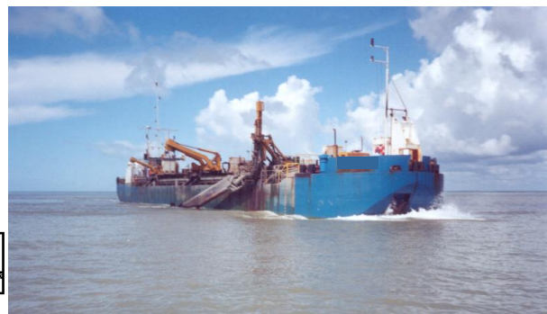
Figura - Dragas Hopper auto-transportadoras em operação
