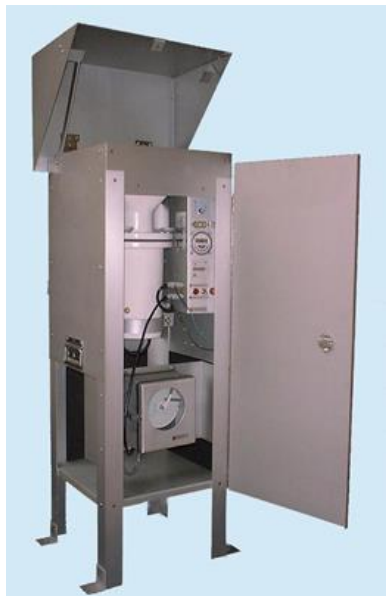
Modelo de um amostrador de grande volume (hi-vol) para medição de partículas totais sedimentáveis
