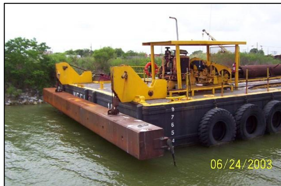
Figura 22. Exemplo de equipamento adaptado para uso em nivelamento de fundo. Foto: Weeks Marine.
