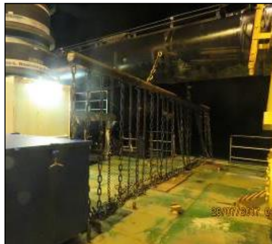
Figura 3. Correntes de afugentamento ( tickler chains ) de tartarugas acoplados às cabeças de dragagem das dragas no Porto do Açu em projetos anteriores. Foto: PHMAR Consultoria.
