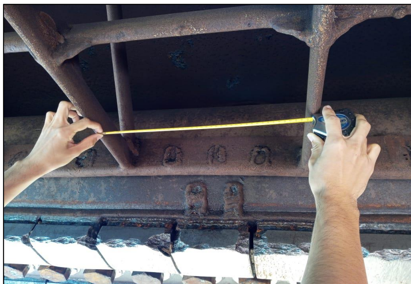
Figura 11. Exemplo de dimensões de grades instaladas na cabeça de dragagem no Porto do Açu. Foto: Control Ambiental.
