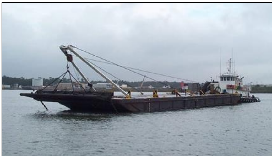
Figura 20.Exemplo de uma barcaça e nivelador. Fonte: Bean Dredging Corp.
