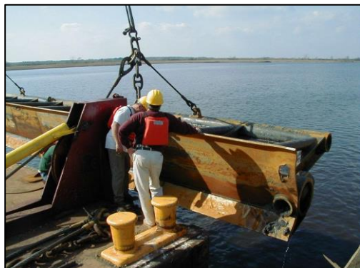
Figura 21. Exemplo de nivelador de fundo desenhado para criar uma onda de sedimento arrastados. Foto: Great Lakes Dredge and Dock Co.
