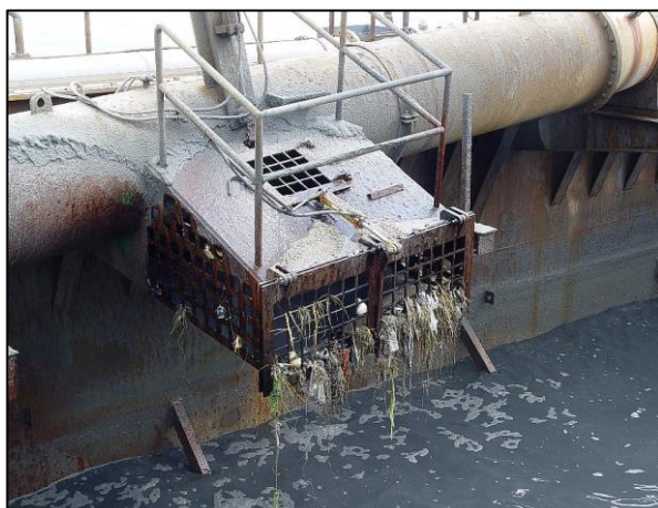
Figura 15. Exemplo de caixa de triagem de material dragado ( inflow screen ) antes do despejo cisterna. Foto: Matthew Godfrey.
