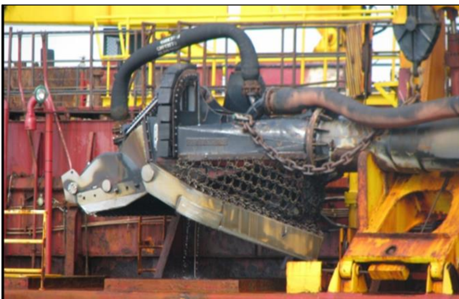
Figura 6. Exemplo de defletor semirrígido articulado com "plataforma fechada" por uma malha de correntes. Fotos: Dena Dickerson.
