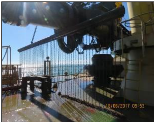
Figura 3. Correntes de afugentamento ( tickler chains ) de tartarugas acoplados às cabeças de dragagem das dragas no Porto do Açu em projetos anteriores. Foto: PHMAR Consultoria.
