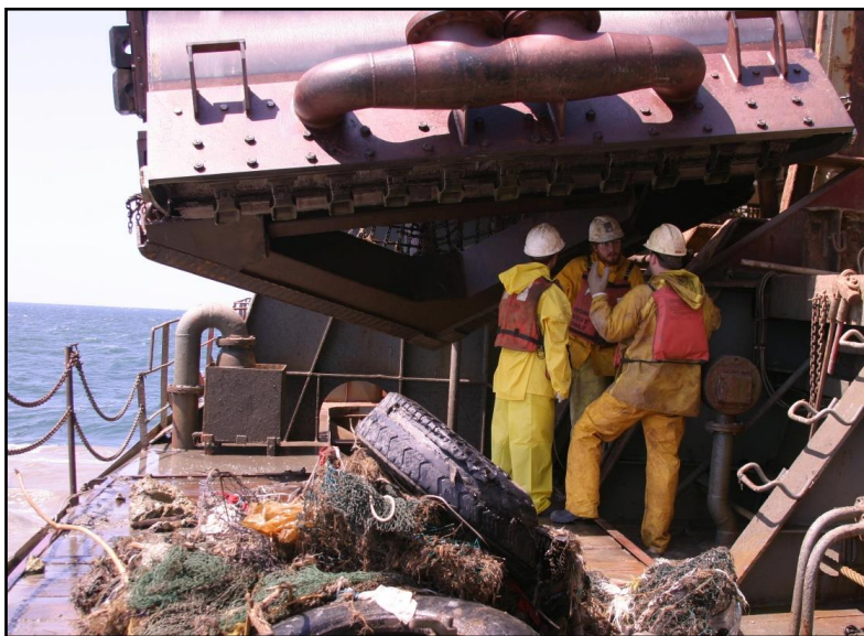
Figura 16. Inspeção da parte inferior de uma cabeça de dragagem e resíduos encontrados. Foto: Dena Dickerson.
