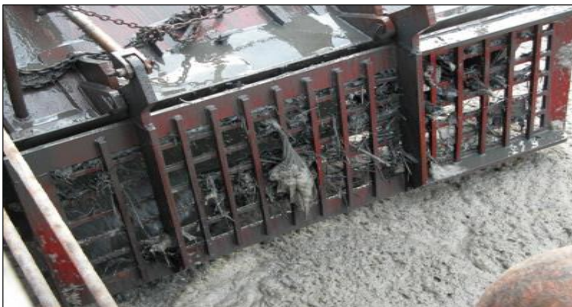
Figura 14. Exemplo de dispositivo para filtrar o material dragado antes da entrada na cisterna ( inflow screen ). Foto: Dena Dickerson.
