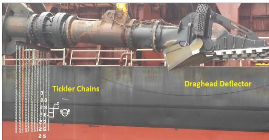
Figura 2. Exemplos de defletores instalados flexíveis (de correntes – Tickler chains ) e defletor rígido ( Draghead deflector ) instalado em uma draga. Foto: Dena Dickerson.
