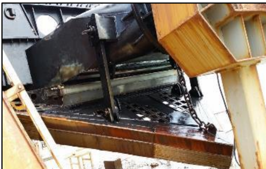
Figura 4. Exemplo de design de defletor com “plataforma aberta”. Foto: Dena Dickerson.
