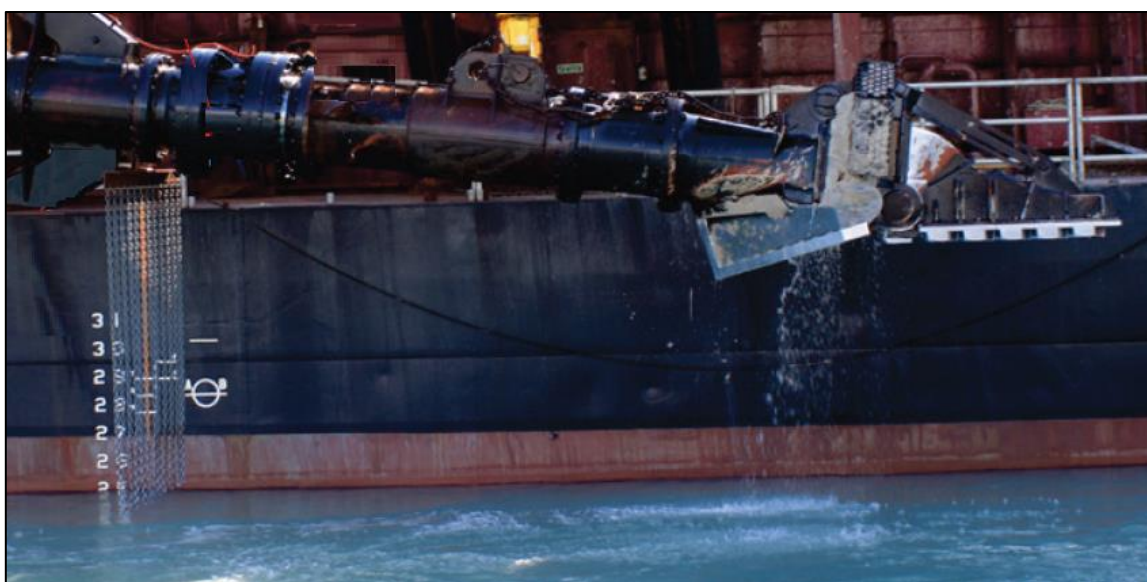
Figura 7. Exemplos de defletores instalados flexíveis (de correntes – a esquerda) e defletor rígido (a direita) instalado em uma draga. Foto: Dena Dickerson.
