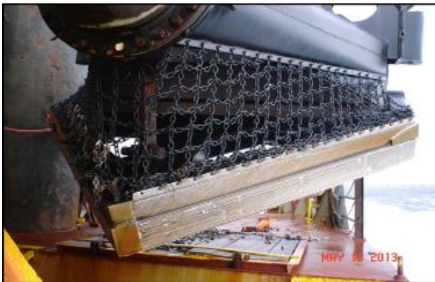
Figura 5. Exemplo de defletor semirrígido acoplado à cabeça de dragagem com "plataforma fechada" por uma malha de correntes. Fotos: Dena Dickerson.
