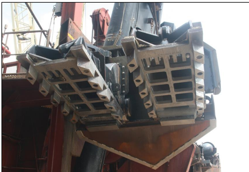
Figura 9. Exemplo de grades instaladas na cabeça de dragagem. Foto: Tim Welp, USACE.
