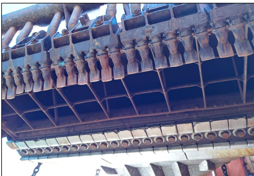
Figura 10. Exemplo de grades instaladas na cabeça de dragagem. Foto: Control Ambiental.
