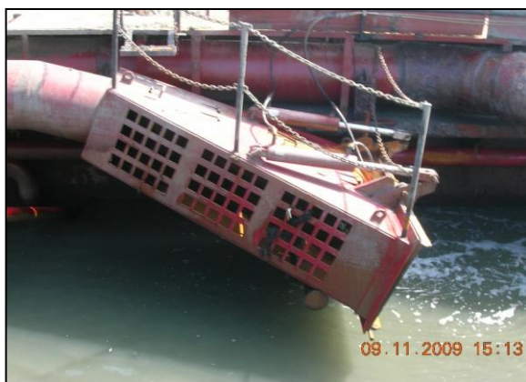
Figura 12. Exemplo de caixa para filtragem do material dragado em draga antes do despejo na cisterna Hopper . Foto: USACE – Savannah District.
