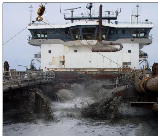
Figura 15. Exemplo de caixa de triagem de material dragado ( inflow screen ) antes do despejo cisterna. Foto: Matthew Godfrey.
